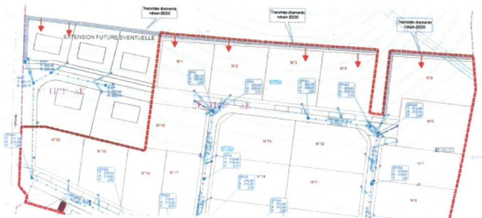
Un bassin de rétention sera positionné en partie basse de l'opération et aura pour fonction de stocker/réguler les eaux pluviales collectées par le réseau pluvial de l'opération : eaux de voiries, eaux de toitures pour l'essentiel. Il sera terrassé à ciel ouvert permettant de faciliter les opérations d'entretiens et de contrôle de police de l'eau. Le rejet régulé rejoindra la rive gauche bétonnée d'un petit ruisseau, affluent du ruisseau de Metzange.
