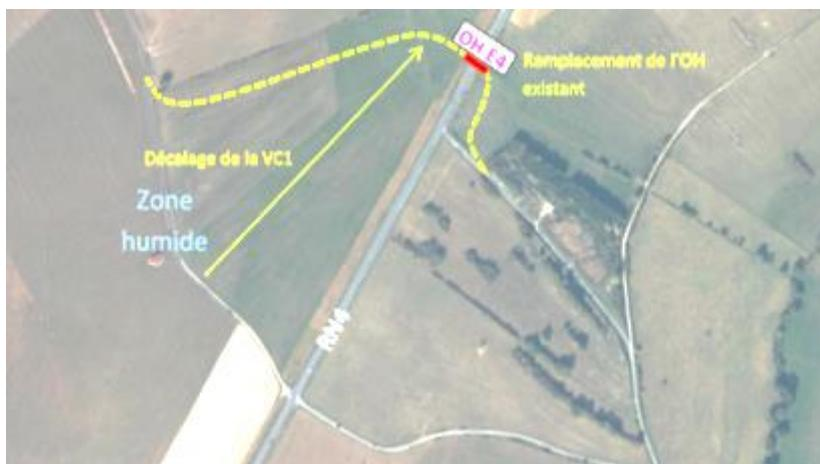
Fig. 51. Décalage de la VC1 et remplacement de l'OHE4
