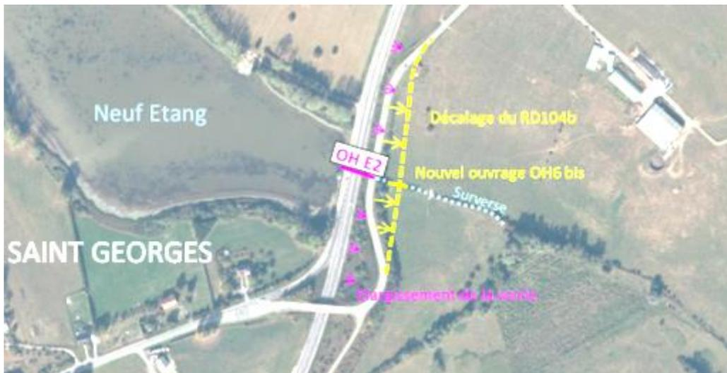
Fig. 55. Décalage de la RD104b et création du nouvel ouvrage OH6bis en aval de l'OHE2
