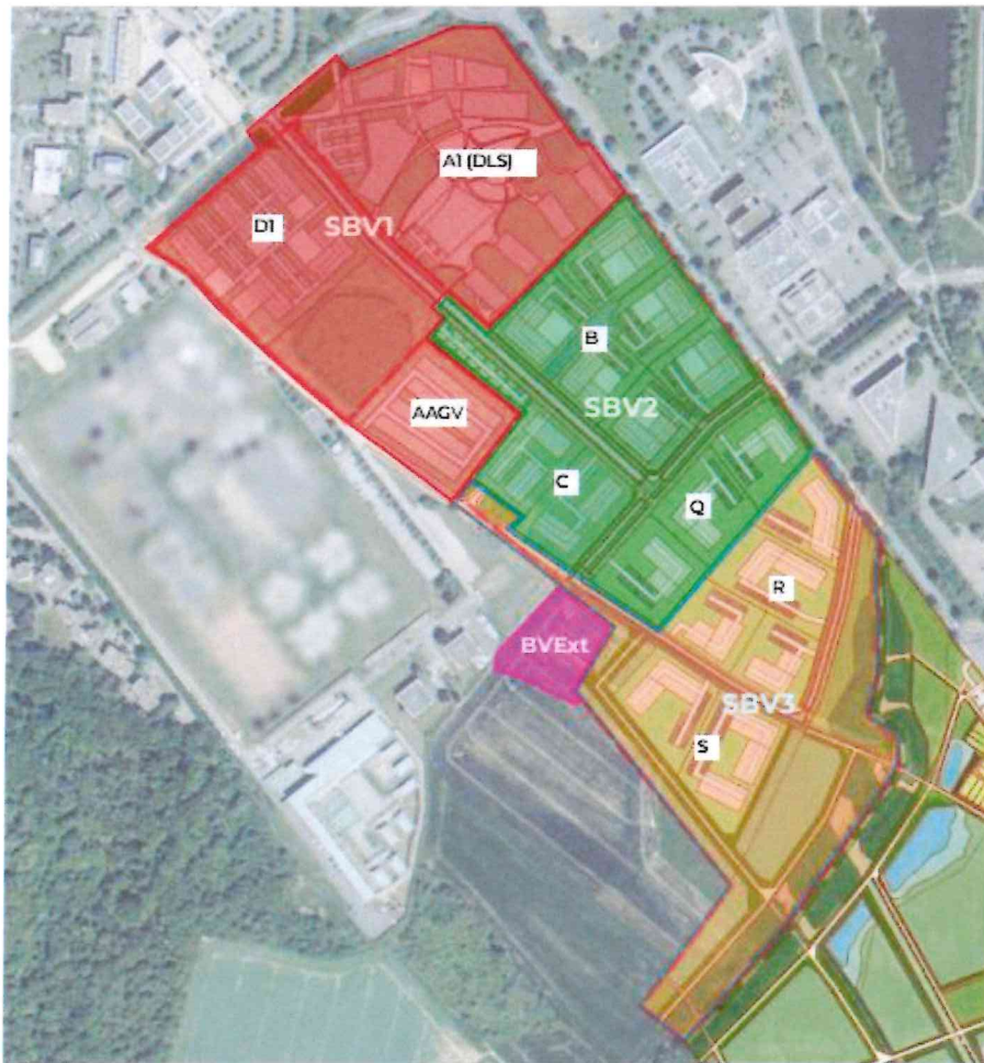
Figure 10 : Définition des sous-bassins versants du projet
