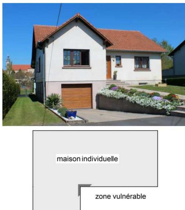
Figure 2.13 : exemple de concentrations de contraintes à la jonction des ailes d'un bâti de forme en « L »
