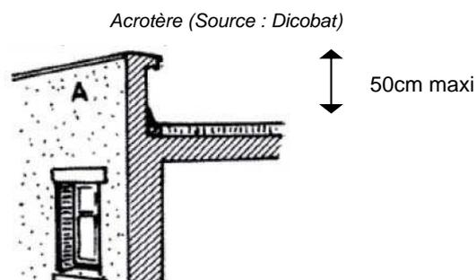
10.3. Lorsque la toiture est plate (moins de 10% de pente), la hauteur de l'acrotère\* devra se placer au moins un mètre en-dessous du niveau de l'égout de toiture de la construction voisine.
