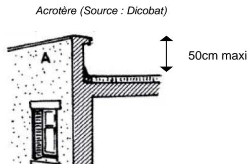
10.3. Lorsque la toiture est plate (moins de 10% de pente), la hauteur de l'acrotère\* devra se placer à au moins un mètre en-dessous du niveau de l'égout de toiture de la construction voisine.
