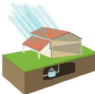
Figure 42 : Schématisation d'un système de récupération des eaux de pluie
