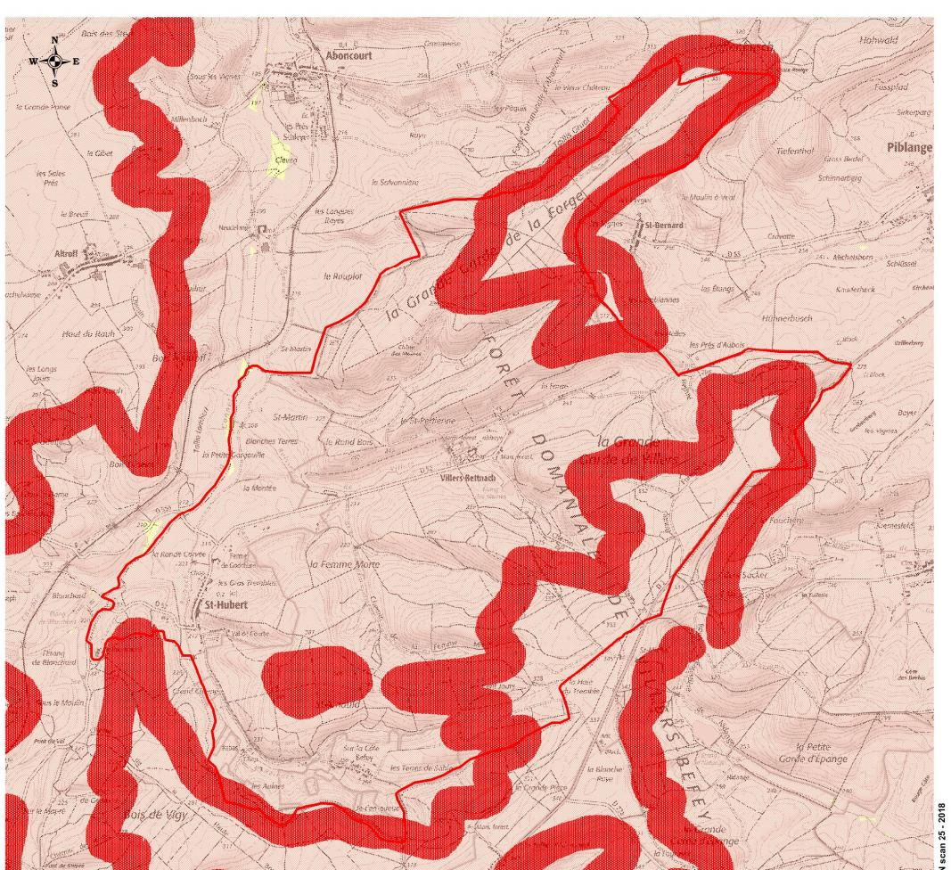
Cartographie des risques de mouvement de terrain différentiel consécutif à la sécheresse et à la réhydratation des sols argileux.
