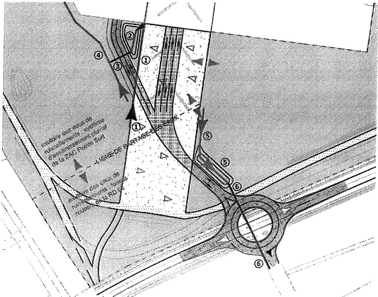
La noue 5 aura un volume de 39 m<sup>3</sup>. La canalisation 6 aura un diamètre de 300 mm avec une pente de 0,01/m/m environ. L'exutoire de cette canalisation est le Renaultrupt. Des regards de décantation seront mis en place afin de retenir les pollutions accidentelles.
